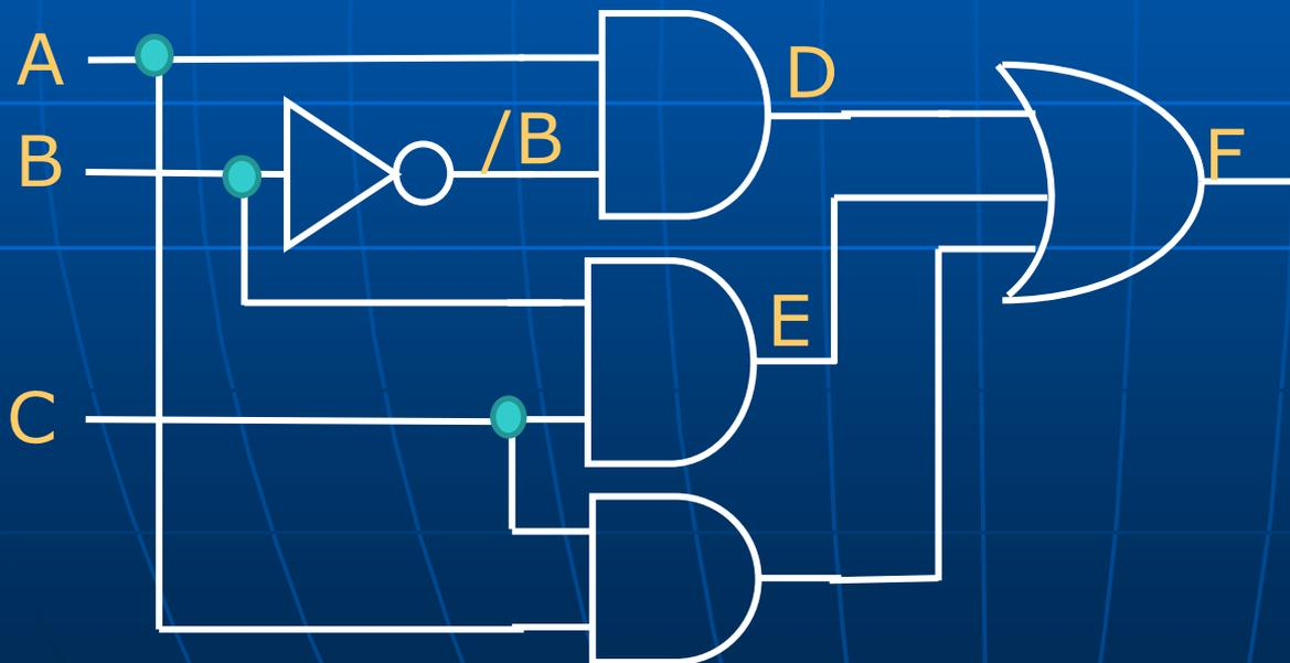
Con esta estructura aunque redundante, se evita que ocurra el riesgo de "1" ya que la compuerta adicional evita que el retardo del negador pueda dar una falsa respuesta.
